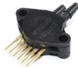
Fig. 1 . Sensor de Presión Diferencial/Manométrica MPX5010DP (0 ~ 10 kPa)
